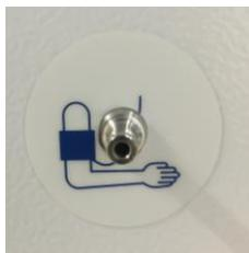
1 pav. Išorinė mova įrenginyje
