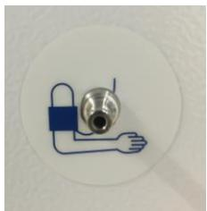
Abb. 1 Männliche Kupplung am Gerät
