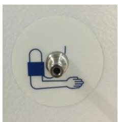
1. ábra Apa csatlakozás a gépen
