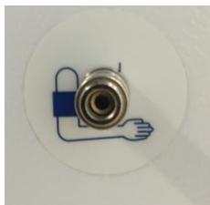
图 3 机器上的雌接口
